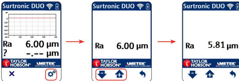
Stellen Sie das Duo auf den mit dem Gerät gelieferten Standard ein (oder auf jeden anderen zertifizierten Standard). Drücken Sie die Messtaste, um eine Messung mit dem Kalibrierungsstandard durchzuführen.
